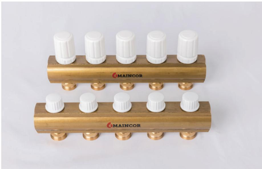
Mainfloor 分集水器（流量计款）选用高品质黄铜原料，壁厚3.5mm，质密度高。高密度热挤压工艺，一次加工成型，破损风险低。品质优于市面常规铜材分集水器，管体内壁光滑平整，水垢杂质不易吸附。超低水阻，超大流量。阀芯全部采用高位出水设计，阀芯防堵塞，使用寿命更长。
